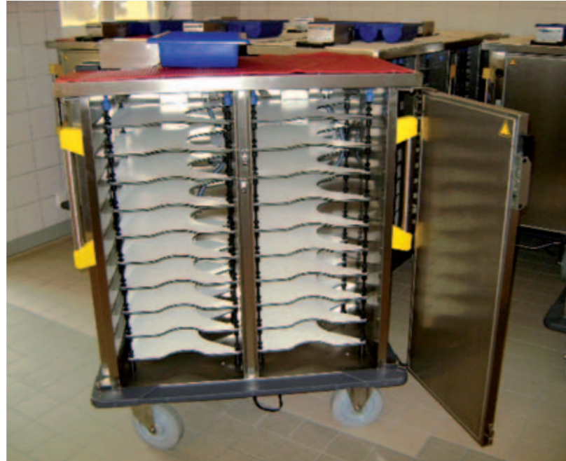
Die neuen Stationswägen werden im Gegensatz zu den bisherigen über stationäre Einheiten mit Energie versorgt.
